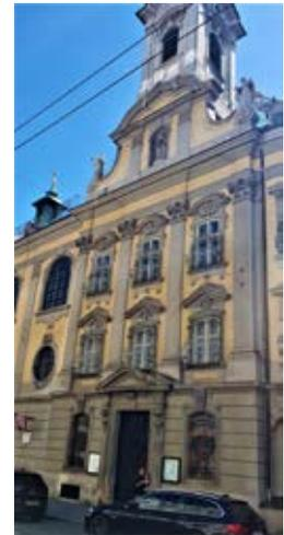
Abb. 12a2 (rechts): An dieser Fassade wurden fälschlicherweise die Elemente (Vokabel) des tektonischen Aufbaus, die in der Nullebene liegen (Fries, Füllung der Parapetfelder), wie diese gefärbt, wodurch sie zu Fehlstellen im Aufbau wurden. Foto: Friedmund Hueber
