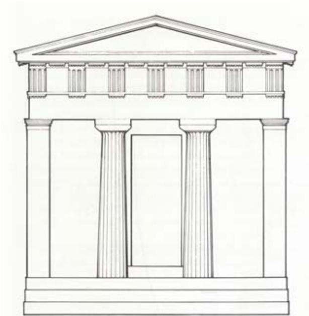
Abb. 3a und b: Dorischer Tempel mit Sockelbau, Stützgliedern, Gebälk und Giebel (links). 3-lagiges Gebälk ionischer Ordnung (rechts). Auf dem Kapitell liegt der Architrav mit Zierprofil als oberen Abschluss, darauf der glatte Fries, auf dem das Gesimse mit Zahnschnitt ruht. Quelle: R. Chitham, Die Säulenordnungen der Antike, 1994
